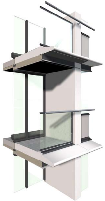
Doorsnede balkon | Section balcony
