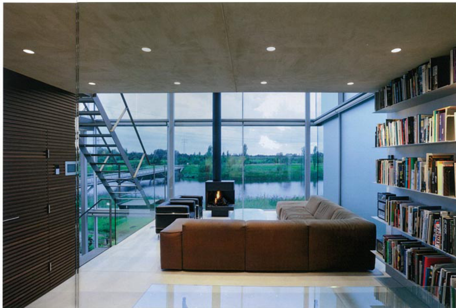
Bibliothèque dessinée par l'architecte. Spots Smart Lodis LED intégrés au béton du plafond.
