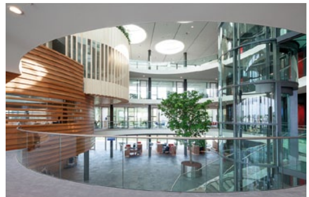
De publiekshal met panoramalift en daklichten; links de raadzaal met gebogen glasstroken en daarboven de bestuurskamer. In de koepels zijn Duco GlasMaxTronic elektronisch gestuurde ventilatieroosters geïntegreerd. Foto: Imre Csany.
